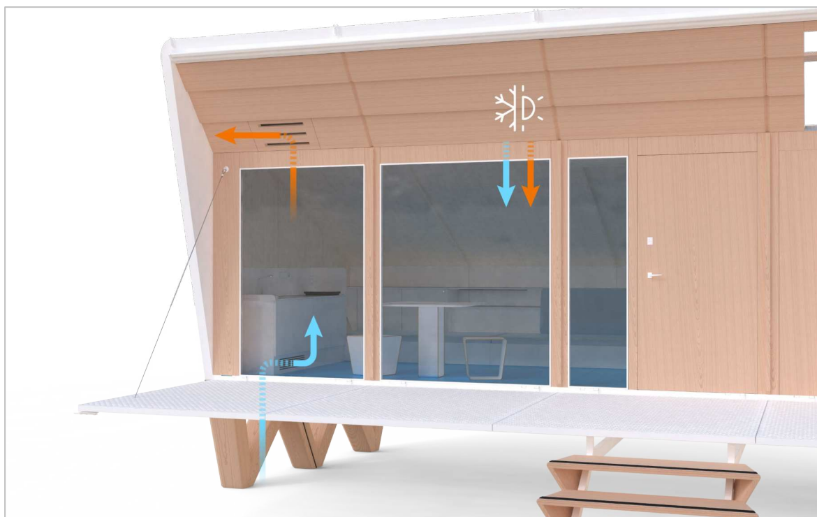
Obr. 6-34 Proudění teplého a studeného vzduch v modulu
