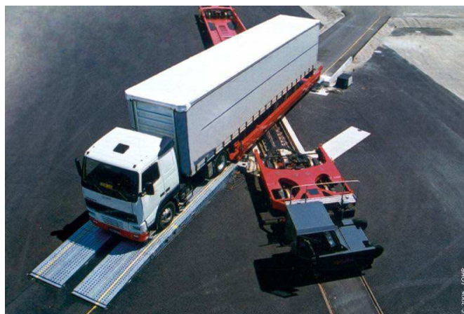
Obr. 2-22 Princip naložení celého nákladního auta na vlak [36]
