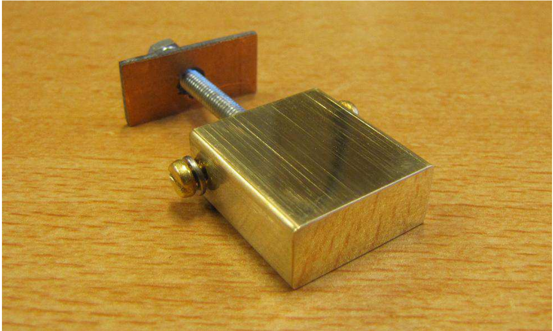
Obr. 5.2: Ladicí pístek včetně aretačních šroubů a ladicího mechanismu
