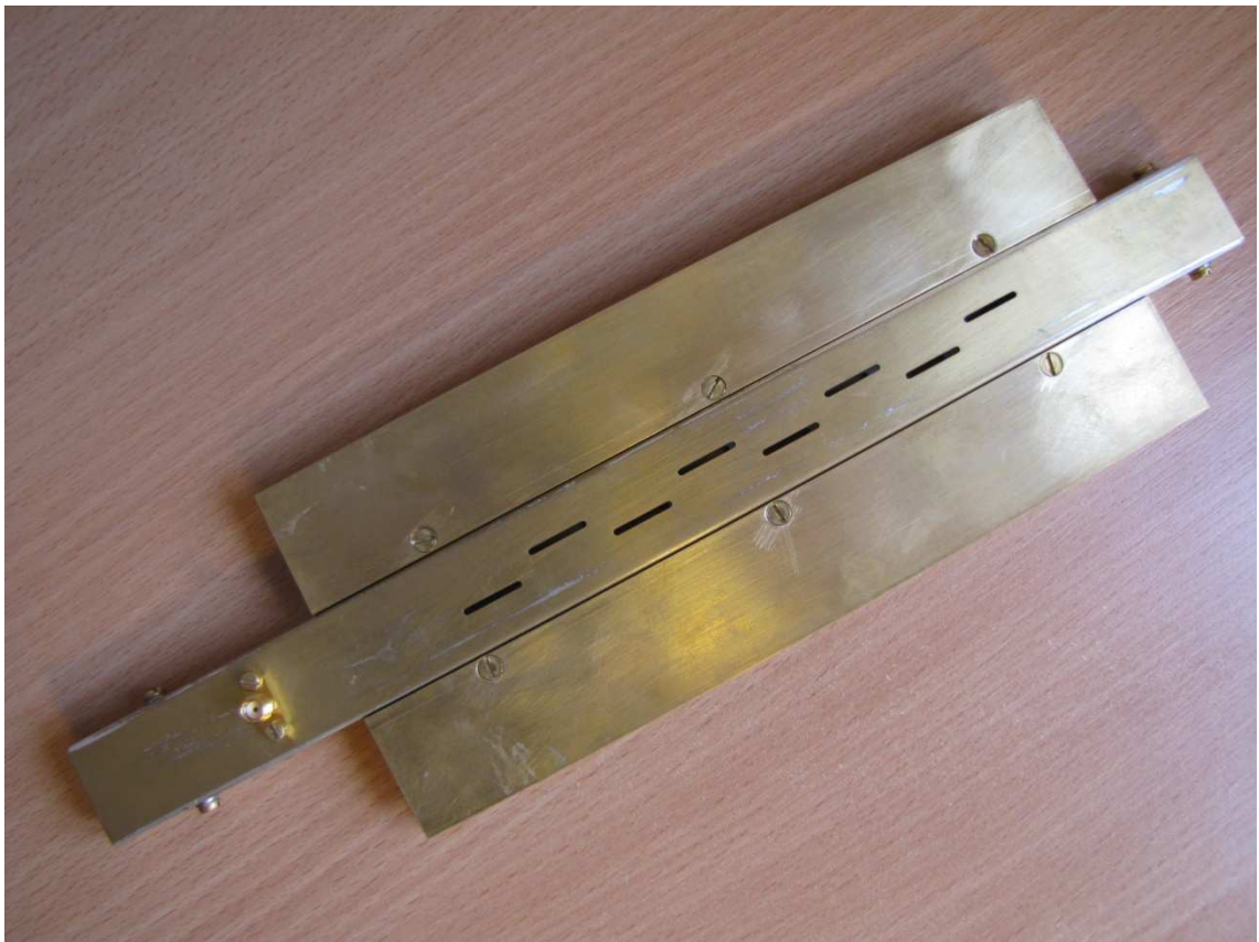
Obr. 5.6: Zkompletovaná anténa s přídavnou zemní rovinou
