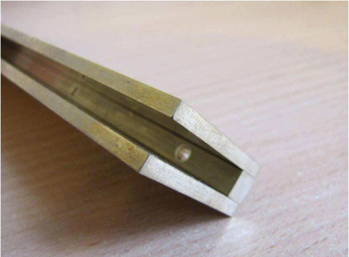
Obr. 5.4: Detail konstrukce přídavné zemní roviny
