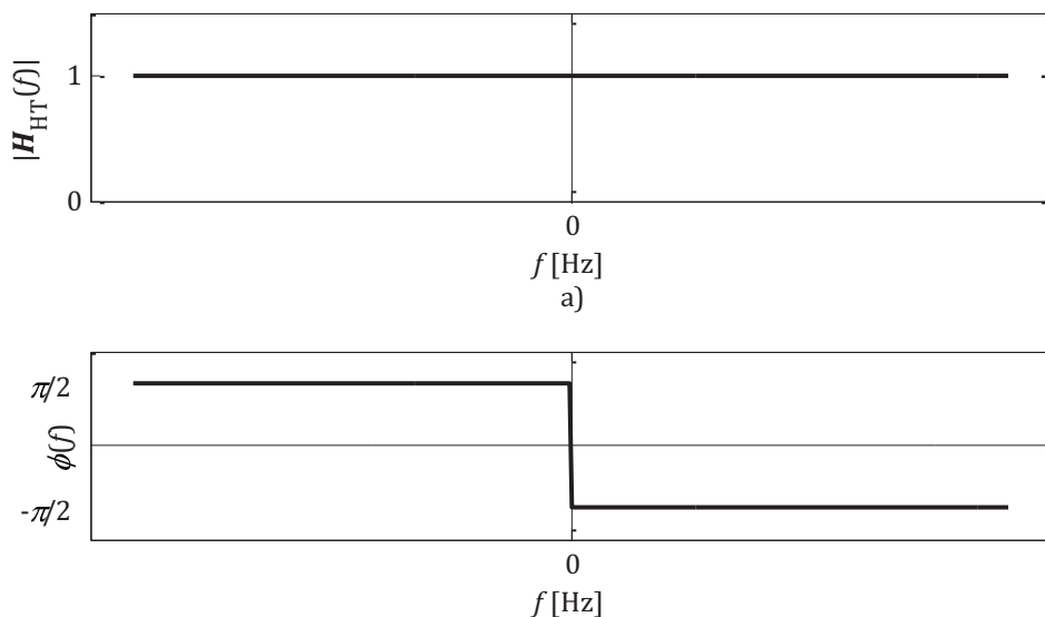
Obr. 2.3: Kmitočtové charakteristiky Hilbertova transformátoru: a) amplitudové spektrum, b) fázové spektrum.
