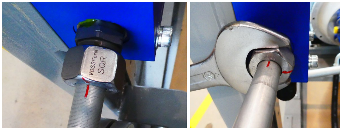
Obr. 19) a) Označení matice fixem, b) Utažení matice a kontrola úhlu
