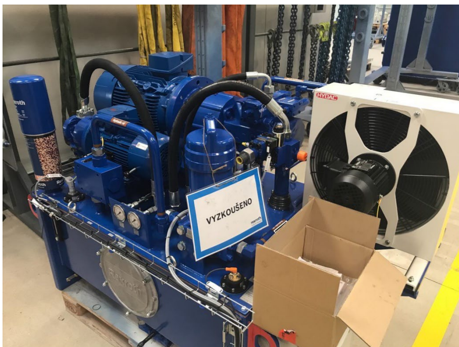
Obr. 15) Označení agregátu po zkouškách
