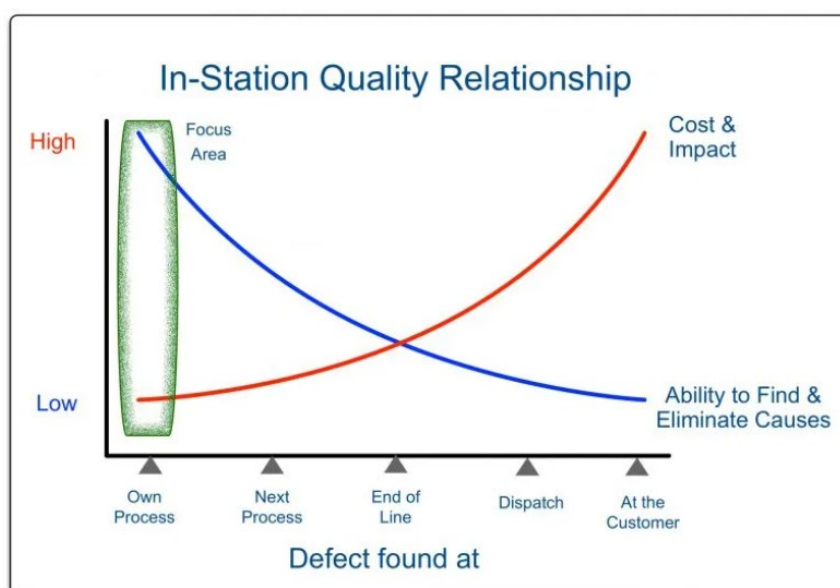
Obr. 1) Závislost nákladů a detekovatelnosti vad na fázi realizace produktu [9]
