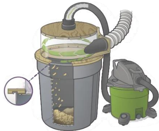
Obr. 48) Princíp systému odsávania pilín [65]
