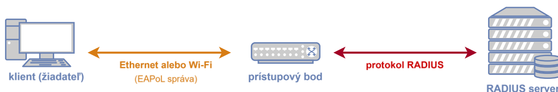
Obrázok 1.5 Komponenty siete s autentizáciou EAP-MD5 a ich vzájomná komunikácia.
