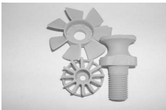
Obr. 5 Součásti vyrobené metodou gelcasting, odlité do gumových forem [8]
