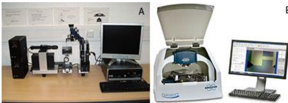
Obrázek 13: (A) Přístroj pro měření kontaktních úhlů Contact Angle System OCA 5 připojený k PC. (B) Profilometr DetakXT firmy Bruker.
