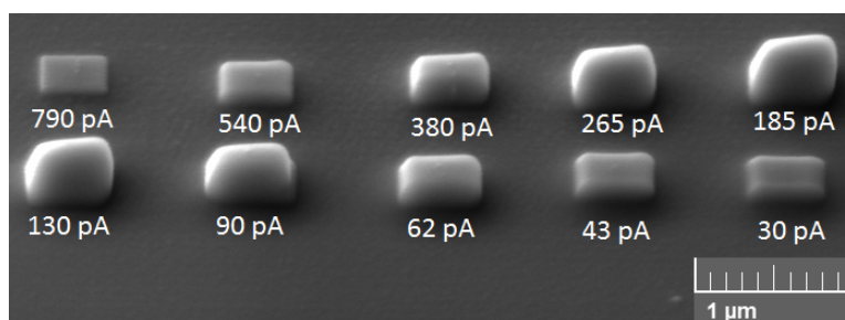
Obrázek 3.7: Připravené 3D kvádry o rozměrech 400 nm x 400 nm. Použité parametry depozice: urychlovací napětí 5 kV, hodnoty proudu v obrázku, "dwell time": 0,5 \mu s, parametr "spacing": 0,7, 30 000 rastrů, parametr "loop time": 10 \mu s.
