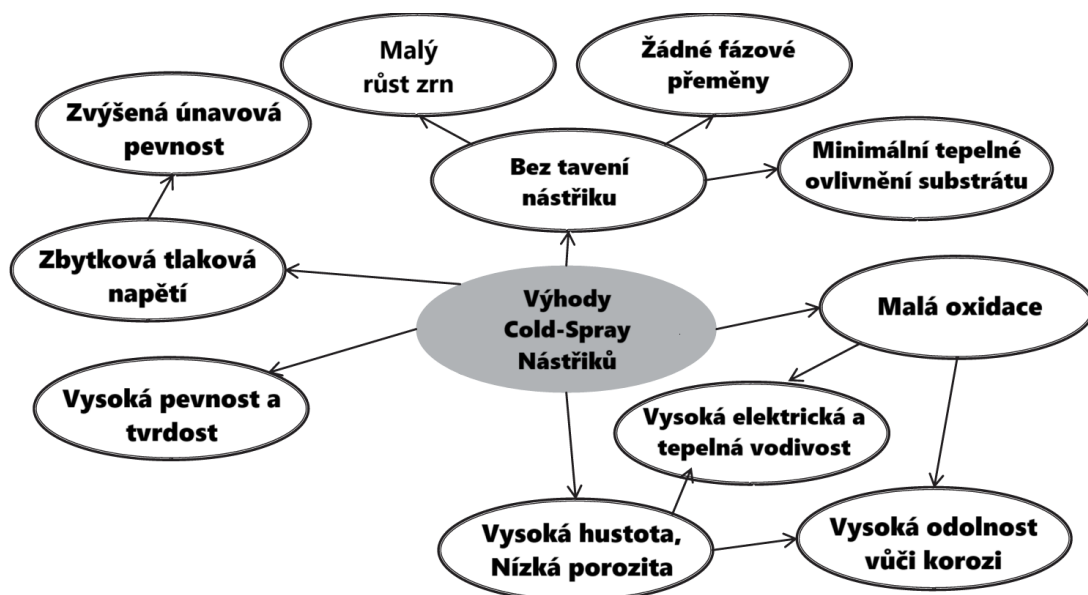
Obr. 10 – Výhody Cold Spray nástřiků, převzato z [10]
