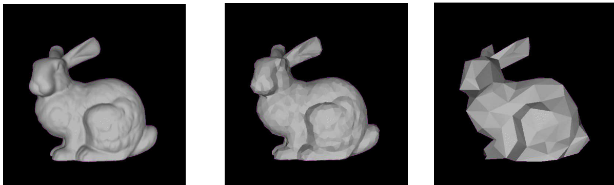
Obrázek 2.3: Různé stupně detailu, první 69 400 polygonů, druhý 2500 polygonů a třetí 251 polygonů. Převzato z [11].
