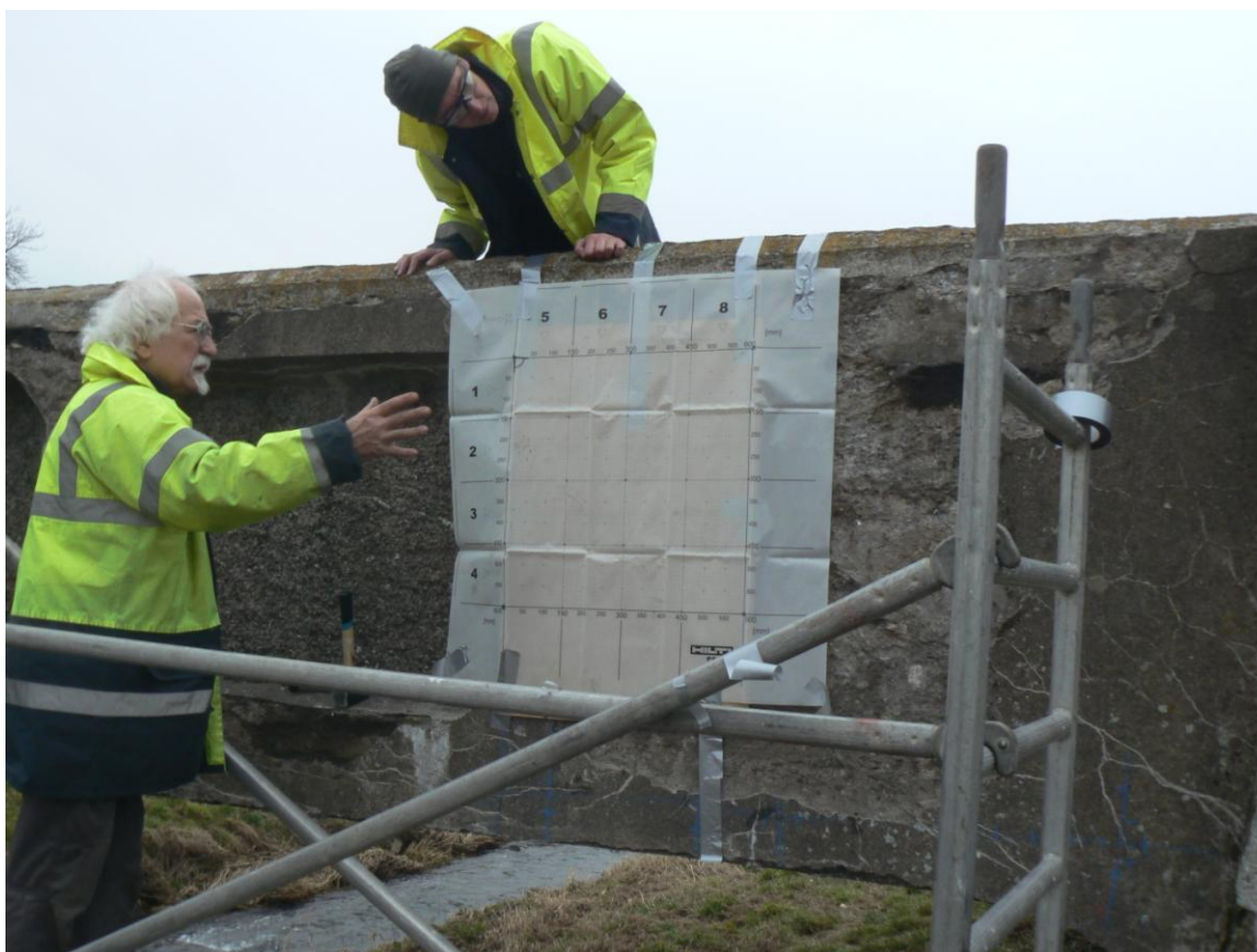
Obrázek 7.4 Rastr 600 x 600 mm připravený pro skenování plochy S1
