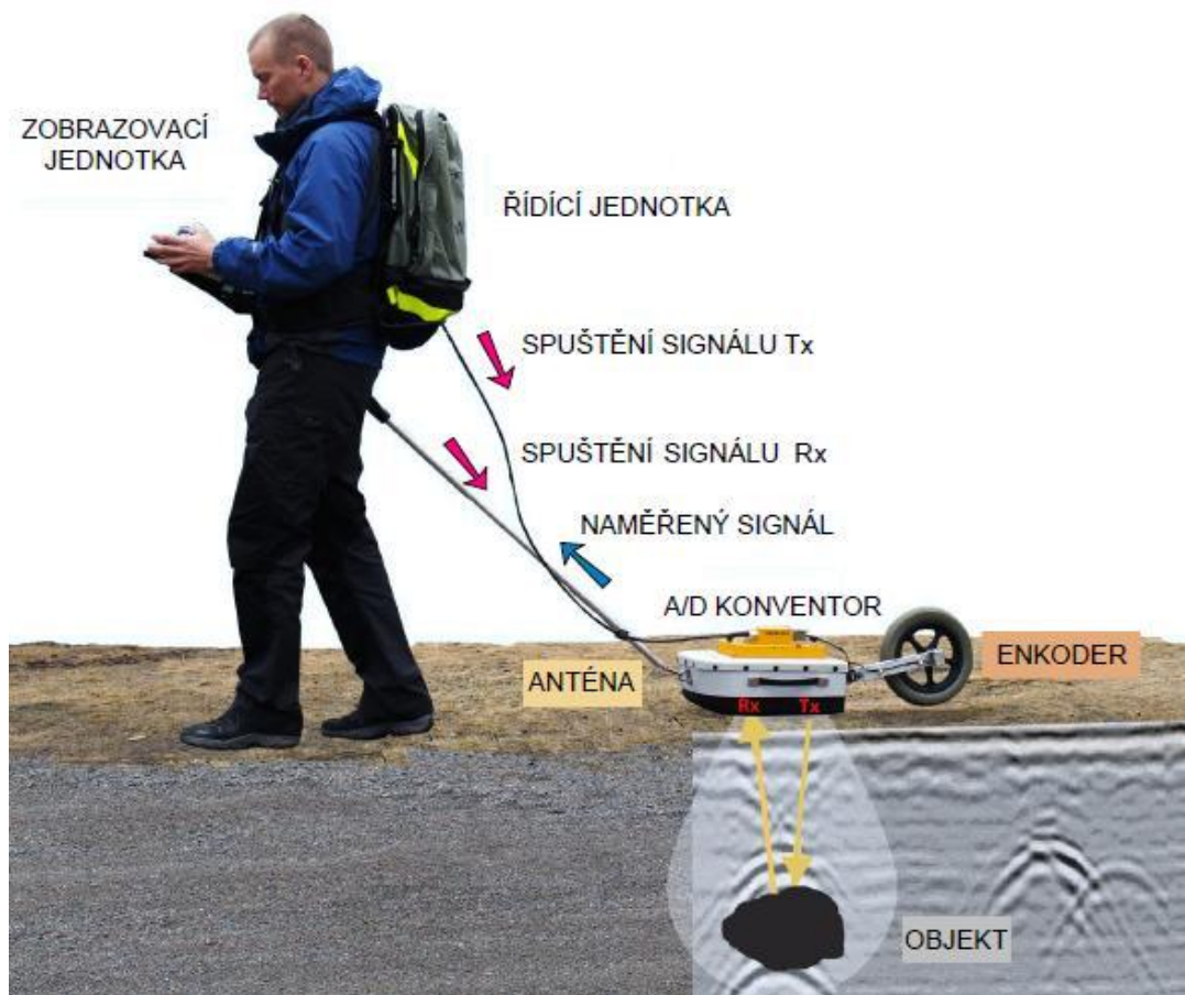
Obrázek 2.4 Princip a součásti GPR (Přeloženo a upraveno) [11]
