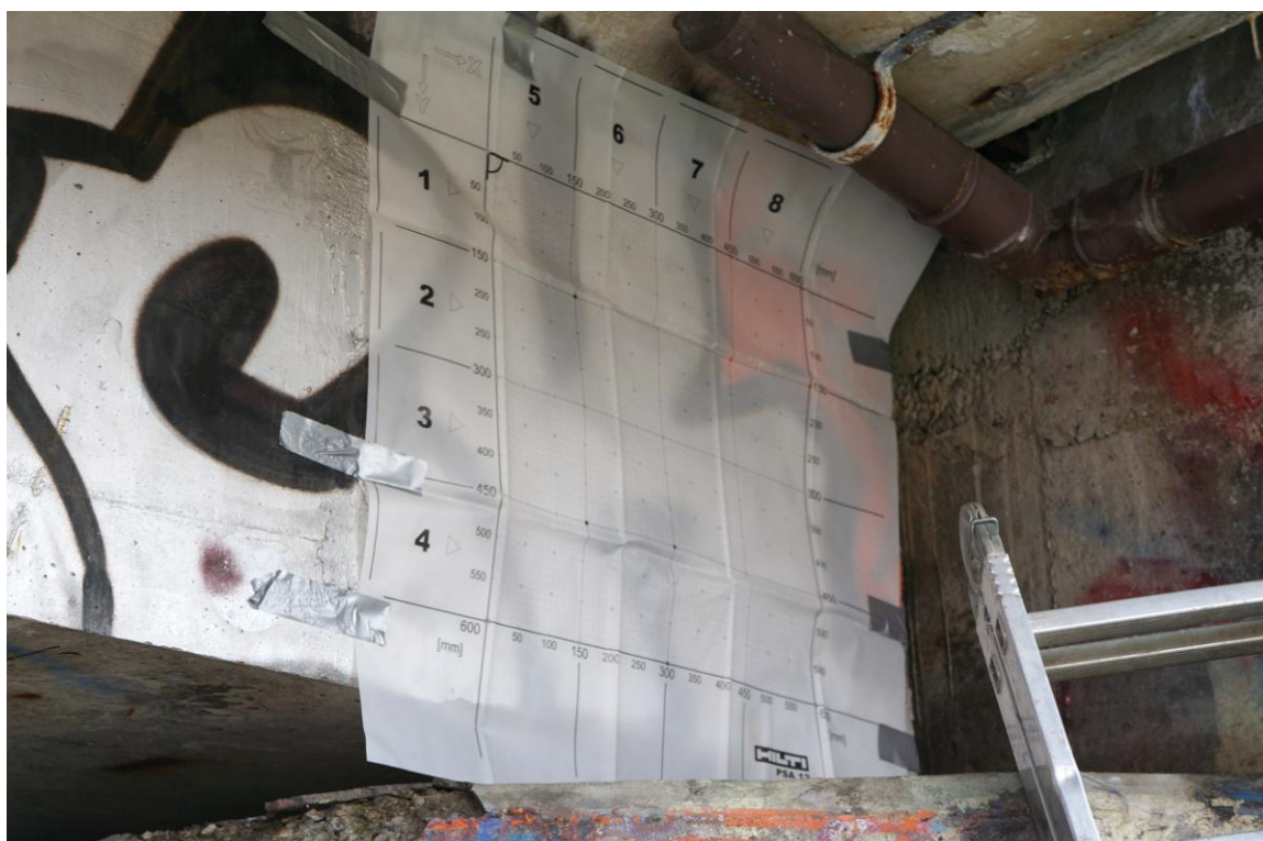
Obrázek 8.4 Rastr pro plošné skenování sondou HILTI PS 1000 X-scan v místě sondy Z12
