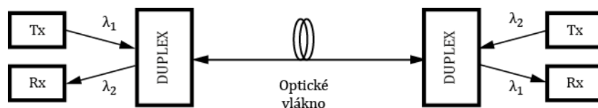
Obr. 3.3: Duplexní režim provozu realizován technologií WDM [5]
