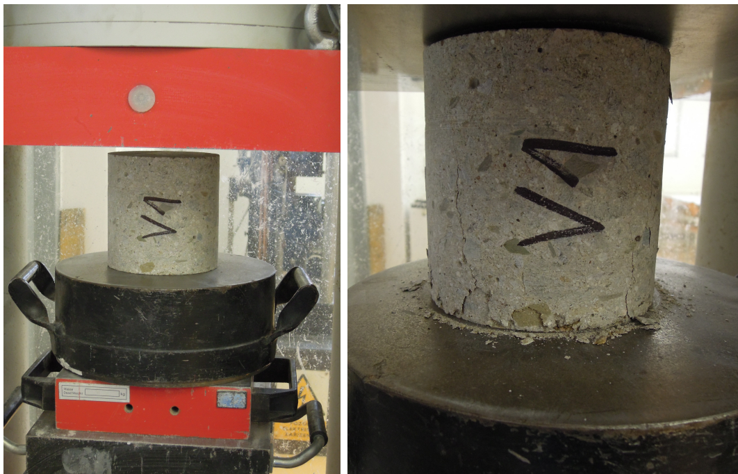
Obr. B.5: Vzorek V1 před a po zkoušení ve zkušební lisu
