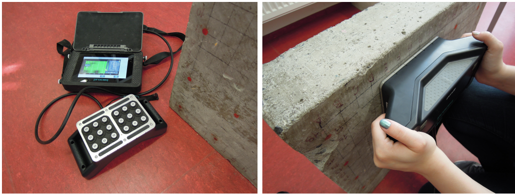
Obr. 2.18: Pundit PL-200PE s odrazovou sondou
