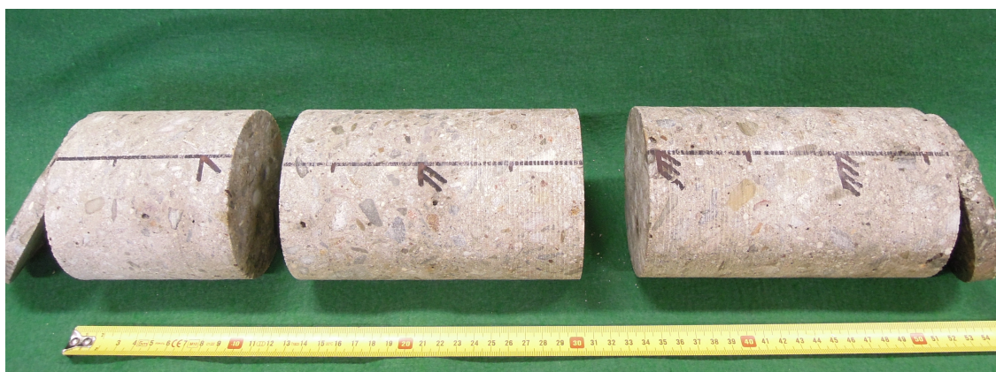
Obr. 2.20: Jádrový vývrt rozdělený na jednotlivé vzorky
