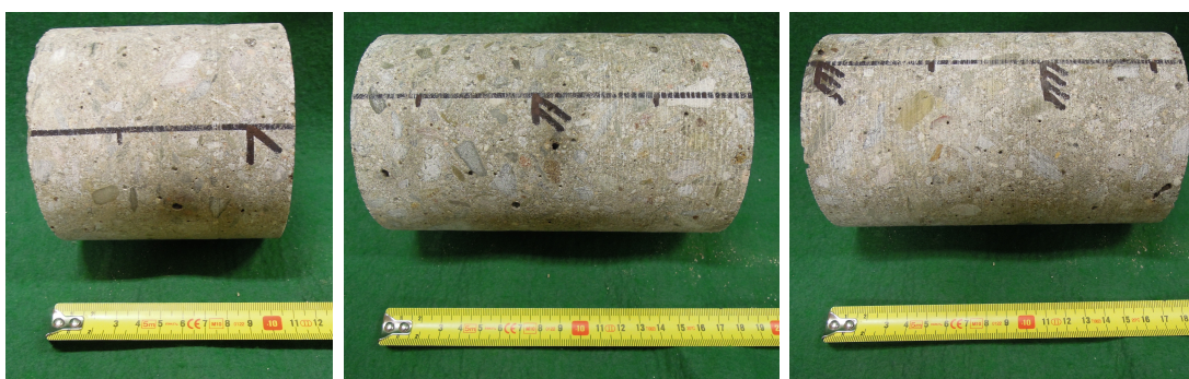
Obr. B.3: Zkušební vzorky z jádrového vývrtnu
