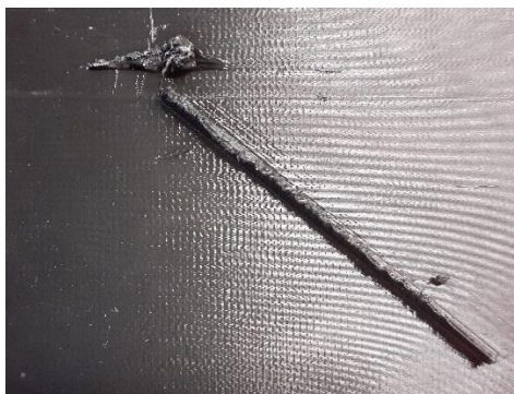
Obr. 3.23 Hrubě vytištěná lamela a shluk materiálu na spodní straně kola.
