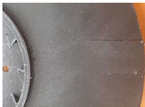
Obr. 3.22 Praskliny na horní straně kola.
