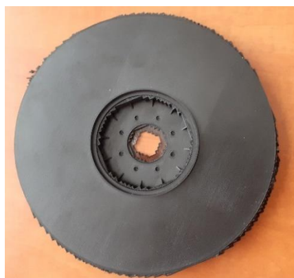
Obr. 3.12 Horizontálně vtištěné kolo.
