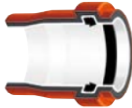
Obrázek 16 Vložení těsnícího kroužku [2]
