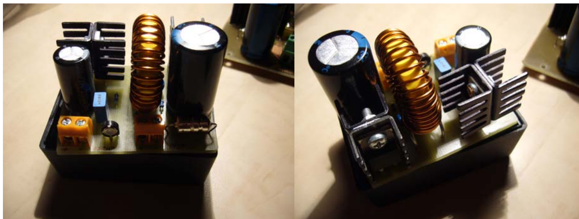
Obr. 35 - hotový měnič s LM2587
