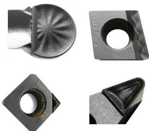
Obr. 58 Lamače třísek zhotovené 3D laserovou technologií [1].
