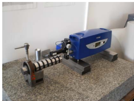
Obr. 52 T AYLOR- HOBSON Form Taly-surf Intra 5.1 při měření vzorku
