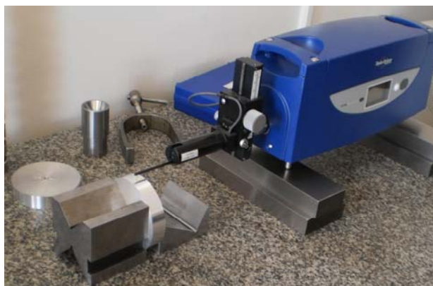
Obr. 36 TAYLOR- HOBSON Form Talysurf Intra 5.1 při měření vzorku
