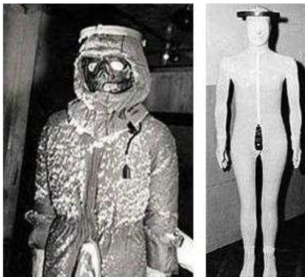
Obr. 4.6 Testování zimního oděvu (vlevo) a vylepšená tepelná figurína z 60.let (vpravo) (ENDRUSICK)
