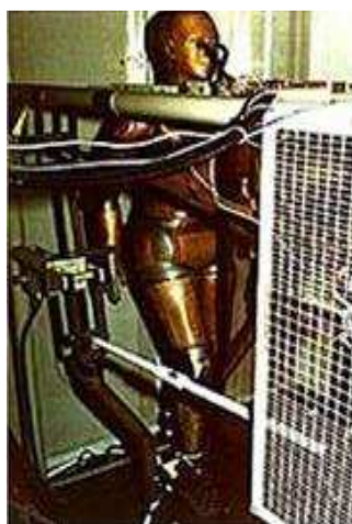
Obr. 4.7 Tepelný manekýn vyrobený institutem USARIEM roku 1984 (ENDRUSICK)
