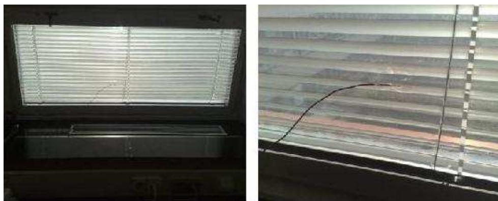
Obr. 7.4 Sonda pro měření okolní teploty
