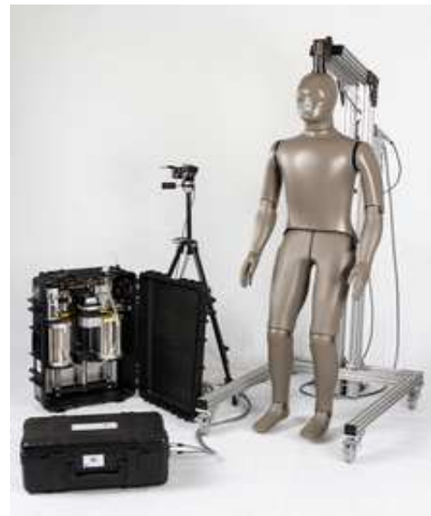
Obr. 4.11 Tepelný manekýn s příslušenstvím (NORTHWEST MEASUREMENT TECHNOLOGY)
