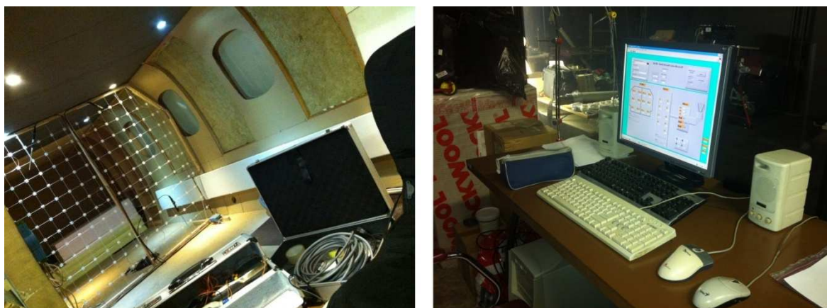
Obr. 8.4 Mříž s 12 termočlánky (vlevo) a počítač se softwarem LabView (vpravo)
