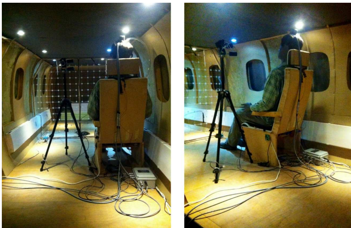
Obr. 8.1 pozice manekýna v maketě malého dopravního letadla
