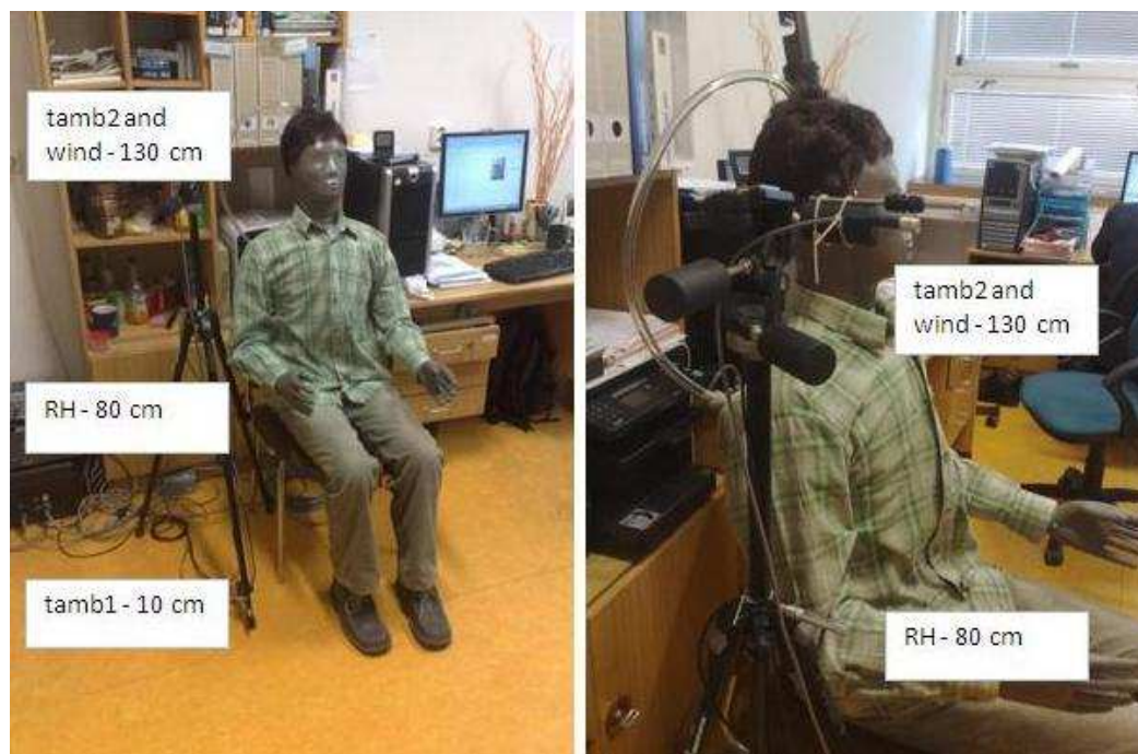
Obr. 7.3 Rozmístění čidel k měření vlhkosti, rychlosti proudění vzduchu a teploty
