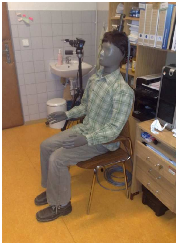
Obr. 7.2 Tepelný manekýn při experimentu v kanceláři
