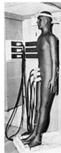
Obr. 4.5 Tepelná figurína vytvořená firmou General Electric (ENDRUSICK)
