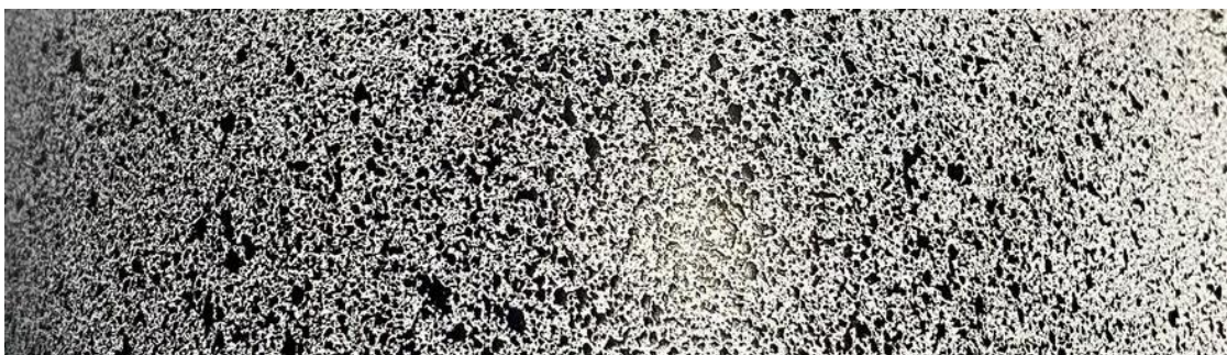
Obr. 25 Detail náhodně vytvořeného vzoru nástřikem.
