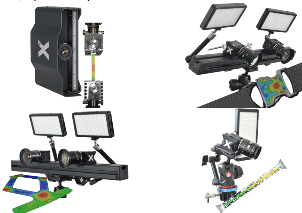
Obr. 1 Aplikace metody DIC [4].
