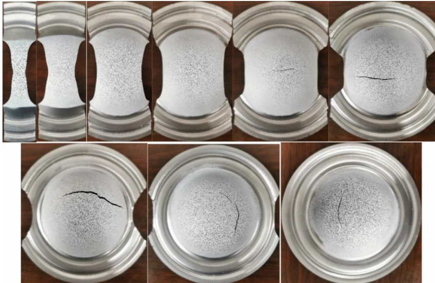
Obr. 16 Různé geometrie zkušebního tělesa [21].
