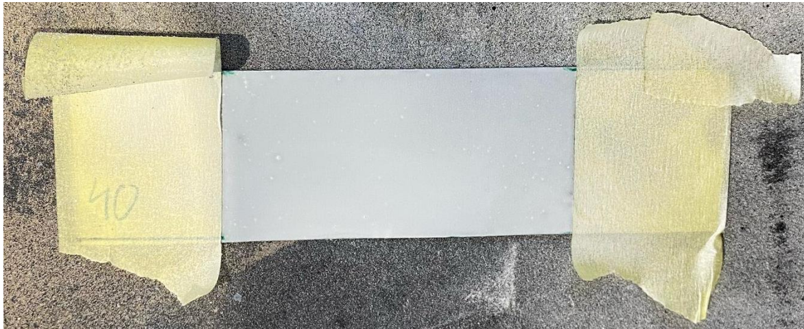
Obr. 63 Oblepení vzorku páskou a nastříkání bílou podkladovou barvou.
