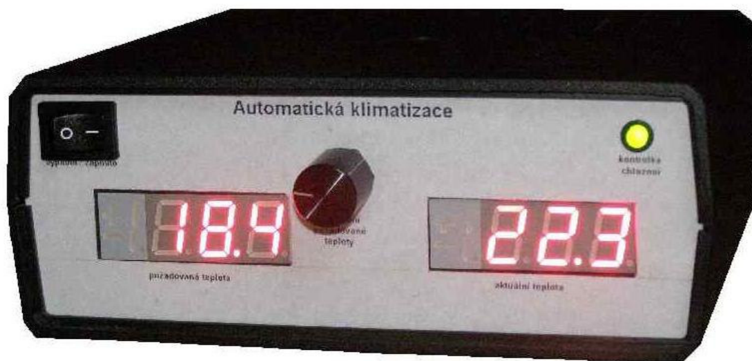
Obr. 38: Fotografie adaptoru manuální klimatizace v činnosti
