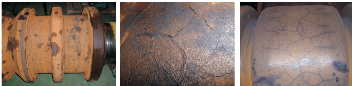
Obr. 2.4: Ukázky poškození válců
