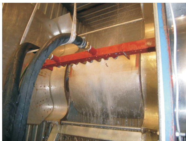
Obr. 4.7: Měřicí válec s osazeným chlazením
