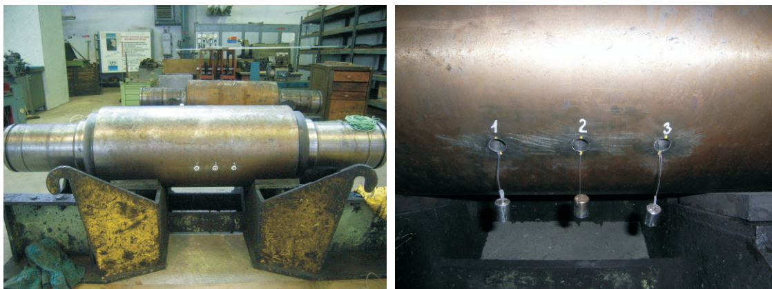
Obr. 4.3: Měřicí válec před osazením čidel
