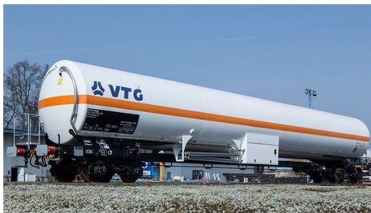
Obr. 4.4 Železniční cisterna na přepravu kapalných plynů[34]
