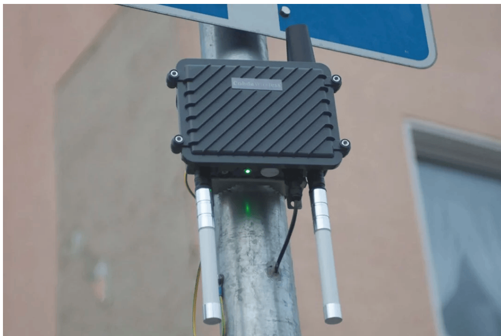
Obr. 5.1: RSU od Cohda Wireless, Zdroj: [6]
