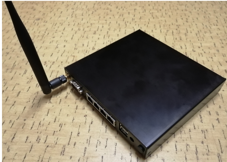
Obr. 6.4: Linuxová OBU jednotka
