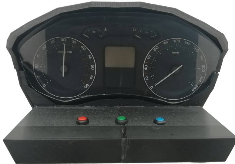
Obr. 13.16: Vytisknutý box pro osazení přístrojové desky
