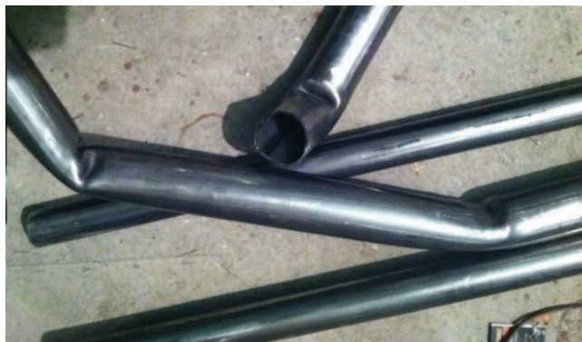
Obr. 1.6 Ovalita ocelových trubek [16]
