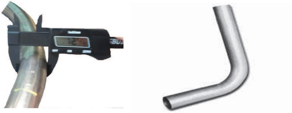
Obr. 1.2 Ovalita trubek a její měření [12], [13]
