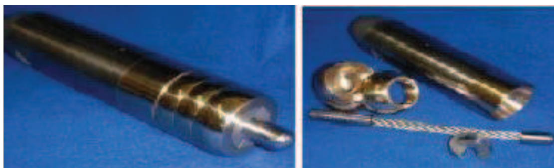
Obr. 2.9, 2.10 Segmentový trn s lankem v celku a v demontovaném stavu [45]
