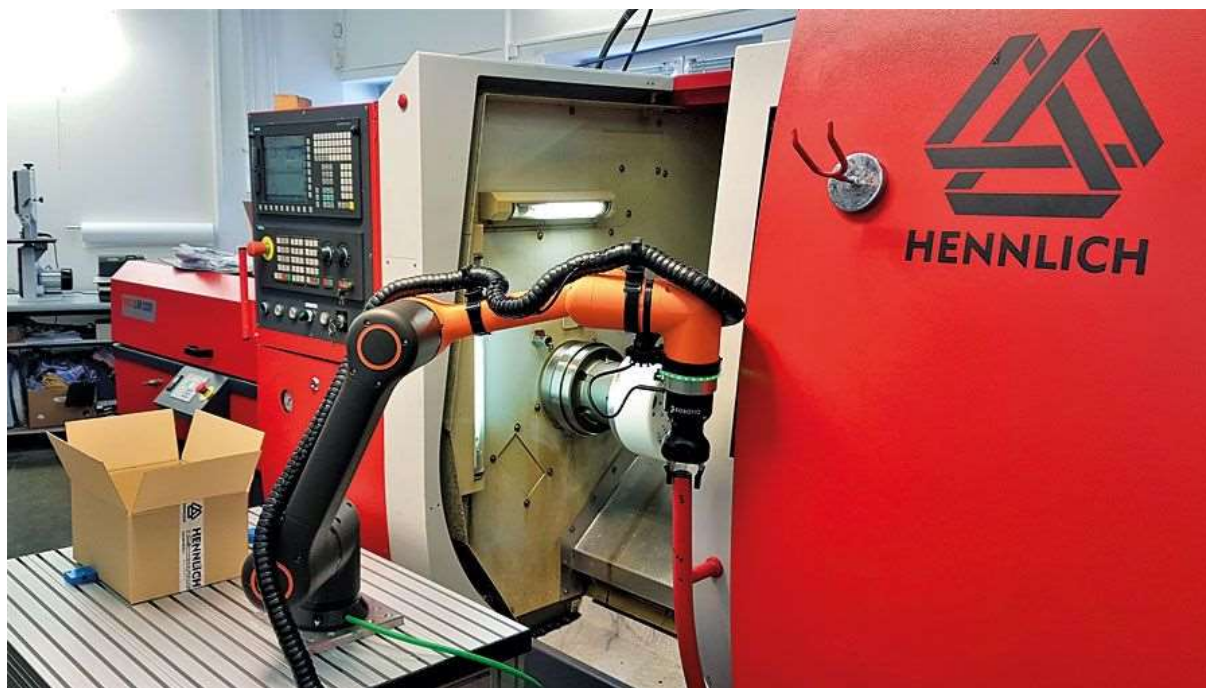
Obr. 13) Kolaborativní robot jako obsluha CNC stroje [26]
