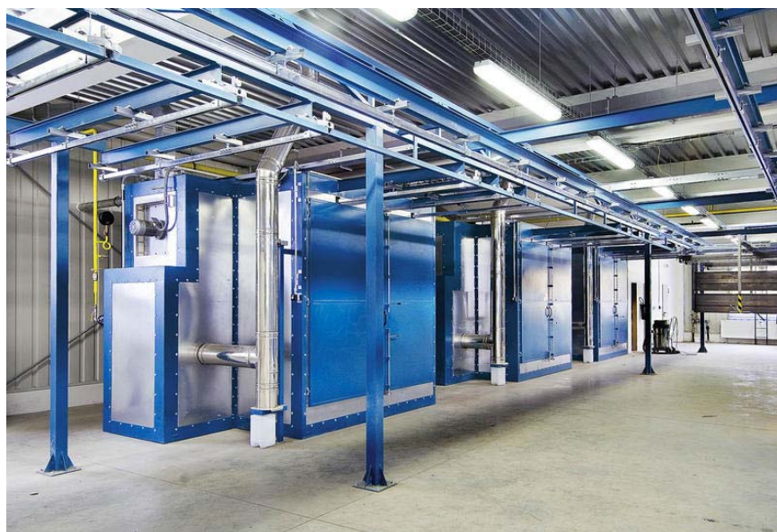
Obr.6.2 Komorová vytvrzovací pec s plynovým vytápěním [9]
