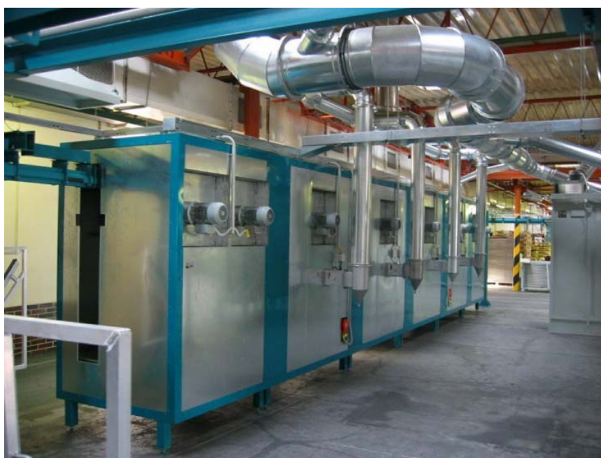
Obr.6.1 Vytvrzovací pec průjezdního typu [9]
