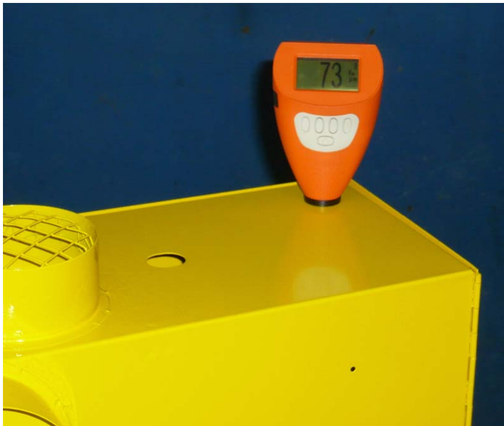
Obr 7.5 Kontrola tloušťky povlaku
