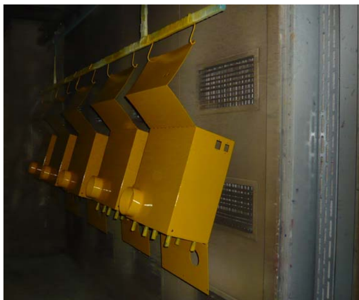
Obr 7.6 Dílce v peci po vytvrzení
