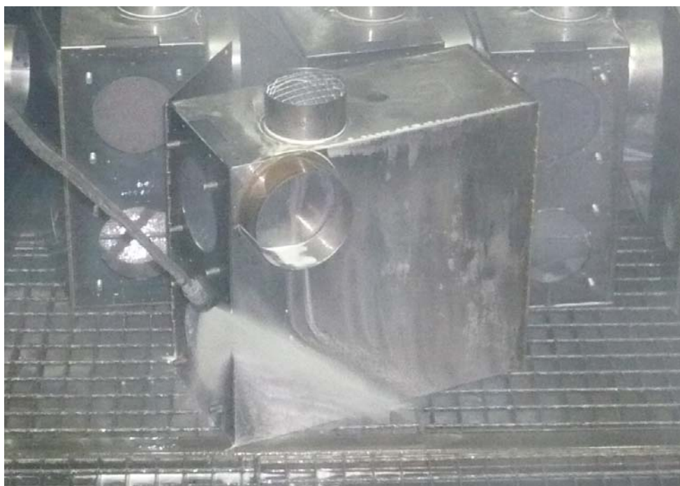
Obr 7.2 Dílec při provádění předúpravy
