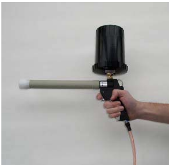
Obr.5.1 Elektrostatická stříkácí pistole Jevan - Prsten 031 [10]
