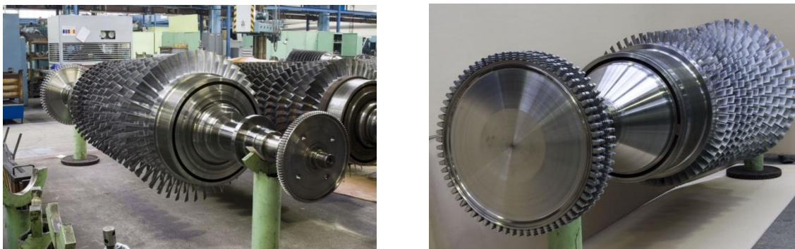
Obr. 1.3 Plynová turbína po opravě [3].
