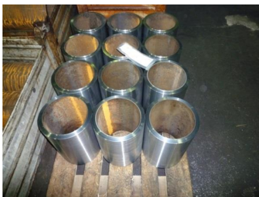
Obr. 3.4 Obrobek po první soustružnické operaci.
