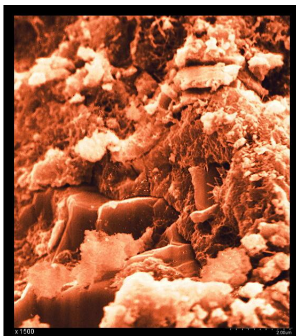
Obrázek 5.9 Maltové směsi s náhradou cementu elektrárenskými popílky Ledvice (a), Dětmárovice (b) a Mělník (c, d) – a) 35% náhrada cementu ELE, pozorování po 28 dnech zrání, pozorována kulová zrna popílku s hydratačními produkty C – S – H, zvětšeno 2000x, b) 35% náhrada cementu ELE, pozorování po 90 dnech zrání, pozorována nespojitost systému pórů, zvětšeno 3000x, c) a d) 35% náhrada cementu ELE, pozorování po 28 dnech zrání, poměrně velké množství hydratačních produktů C – S – H
