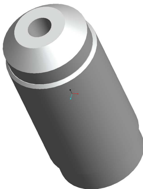
Obr. 5.7 Přípravek pro uchycení kulového čepu při zkoušce
