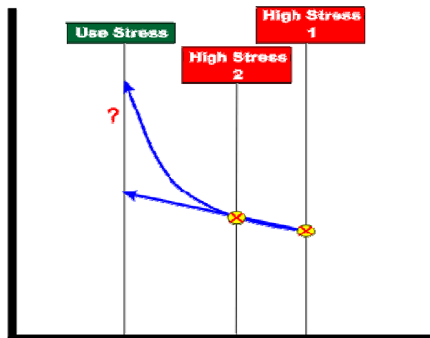
Obr. 2.9 Testování dvou (více) úrovní zatížení [3]
