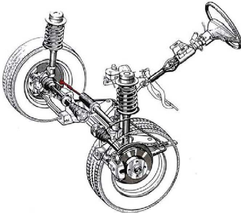
Obr. 4.2 Pozice kulového kloubu v řízení [12]
