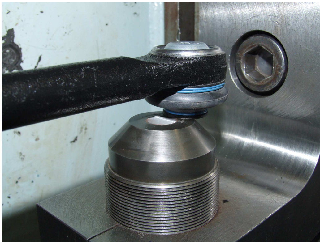
Obr. 6.28 Prasknutí na hraně kuželového uchycení
