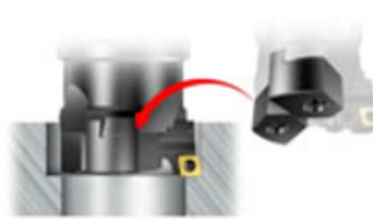
Obr. 15 Vyvrtávání jedním břitem [12]
