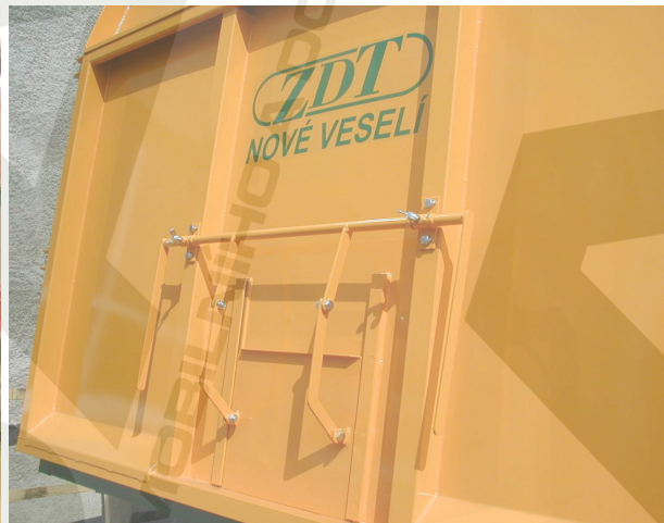
obr. 4.10 - detail výsypného otvoru
