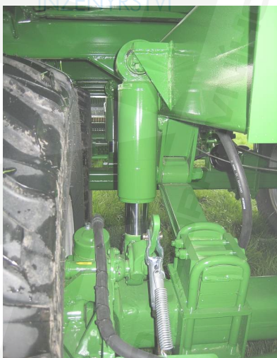
obr. 2.10 – hydraulické zavěšení podvozku [13]
