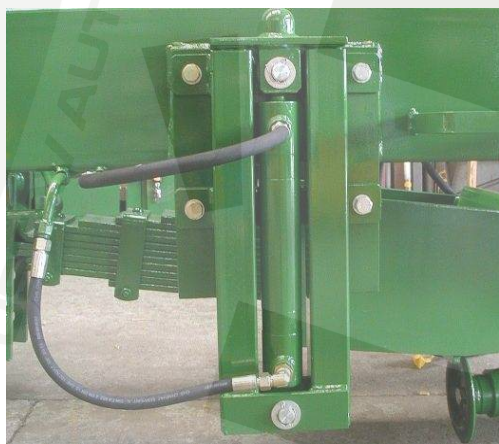
obr. 2.8 – odstavný přímočarý hydromotor [17]
