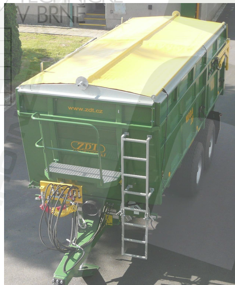
obr. 4.24 – přední čelo: kontrolní plošina, žebřík, rolovací plachta
