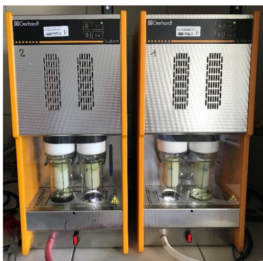
Obrázok 13: Extrakcia olejov na prístroji Soxtherm
