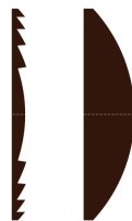
Obr. 2.7: Princip Fresnelovy čočky - řez Fresnelovo (vlevo) a běžnou (vpravo) čočkou (převzato z [16])
