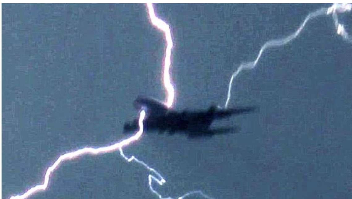
Obr. 3.2 Dopravné lietadlo Airbus A380 zasiahnuté bleskom počas letu. Na obrázku je viditeľné ako blesk vstupuje do lietadla na inom mieste ako lietadlo opúšťa. [26]
