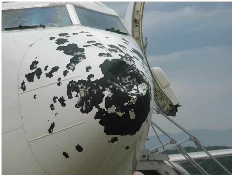
Obr. 3.3 Poškodený letún po prelete oblasťou s krupobitím. [27]
