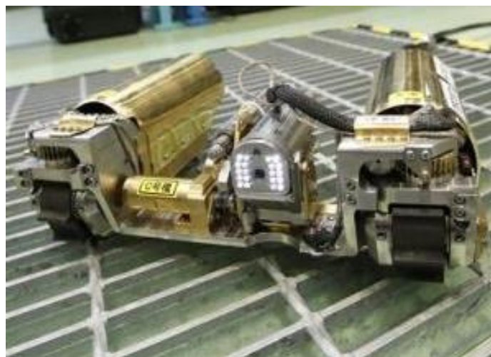
Obr. 5.3 – Průzkumný robot v jaderné elektrárně Fukušima [34]
