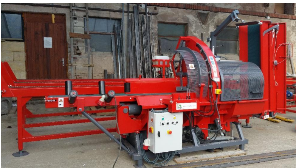
Obr. 4 Štípací automat APD-450, 25 tun, kromě štípaní provádí i řezání pomocí řetězové pily a obsahuje vynášecí pásový dopravník [4]
