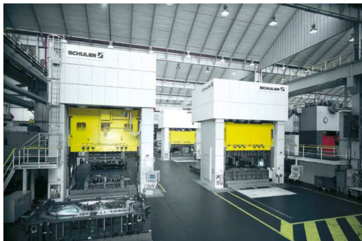
Obr. 01: Flexibilní zapracovávací pracoviště se třemi hydraulickými lisami (Schuler) [1]
