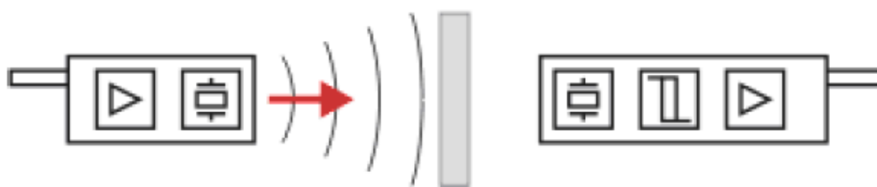
Obr. 4.2 : Dvojhlavý systém (ultrazvuková závora) [8]
