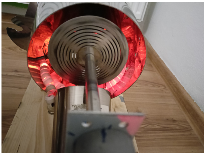
Obr. 7.3: Výhrev pražiacého bubna topným telesom.
