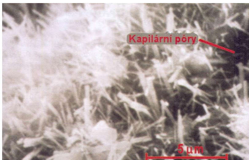
Obr.5 – Kapilární pórovitost cementové pasty [6].
