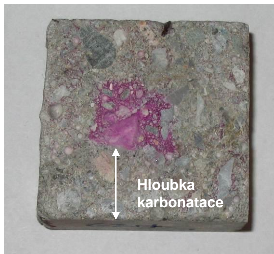
Obr. 11 – Určení hloubky karbonatce pomocí fenolftaleinové zkoušky.
