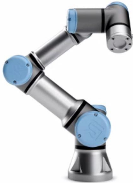
Obr. 6) Kolaborativní robot UR3e [6]
