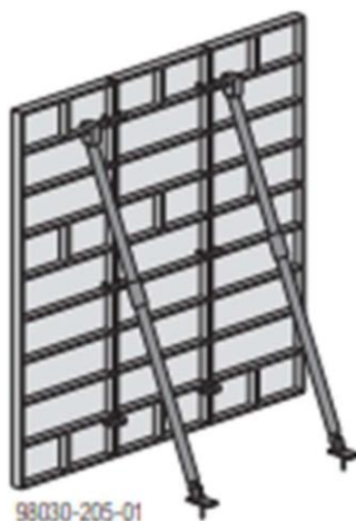
Obr.44, pohled stěny bednění – www.Doka.cz
