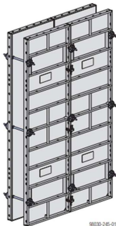
Obr.45, pohled stěn bednění – www.Doka.com .
