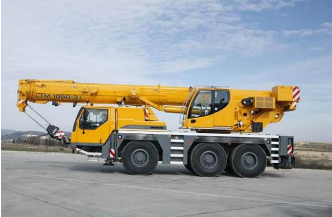
Obr. 6. 9 - Autojeřáb Liebherr LTM 1050 - 3.1
