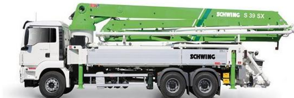
Obr. 6. 23 - Autočerpadlo Schwing S 39 SX
