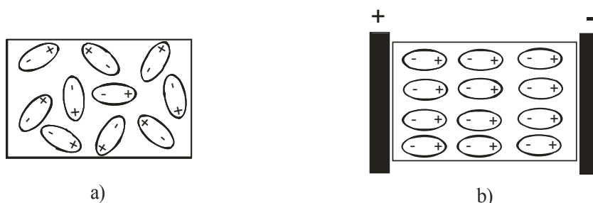
Obr. 2 a) Molekuly polárního dielektrika (bez elektrického pole), b) Polární dielektrikum v elektrickém poli
