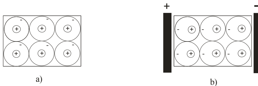
Obr. 1 a) Molekuly dielektrika nepolárního (bez elektrického pole), b) Nepolární dielektrikum v elektrickém poli
