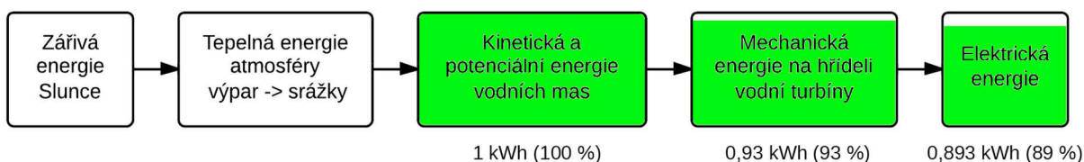
Obr. 6-8: Proces přeměny kin. a pot. energie vodního toku na elektrickou energii s vyznačeným aktuálním množstvím energie v dílčím kroku.
