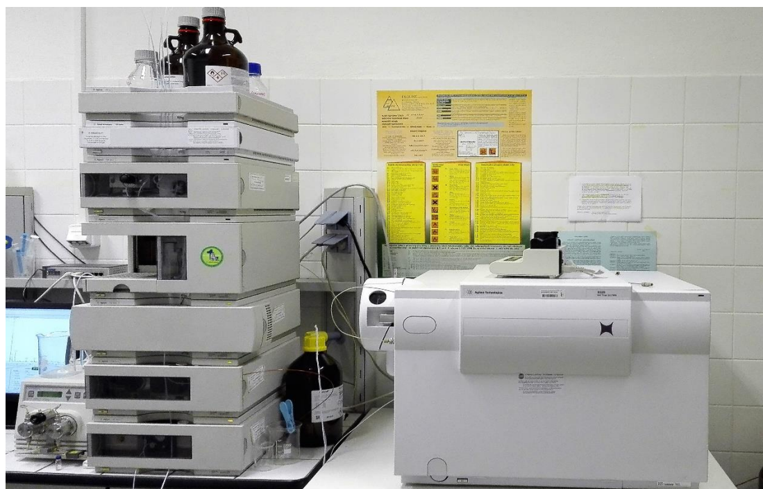
Obrázek 20: Kapalinový chromatograf Agilent 1100 Series a hmotnostní spektrometr Agilent Technologies 6320 Series Ion Trap LC/MS
