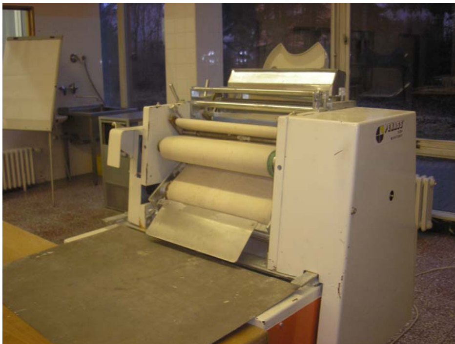
Obrázek 2: Příklad na tvarování rohlíků, tzv. rohlíkáč
