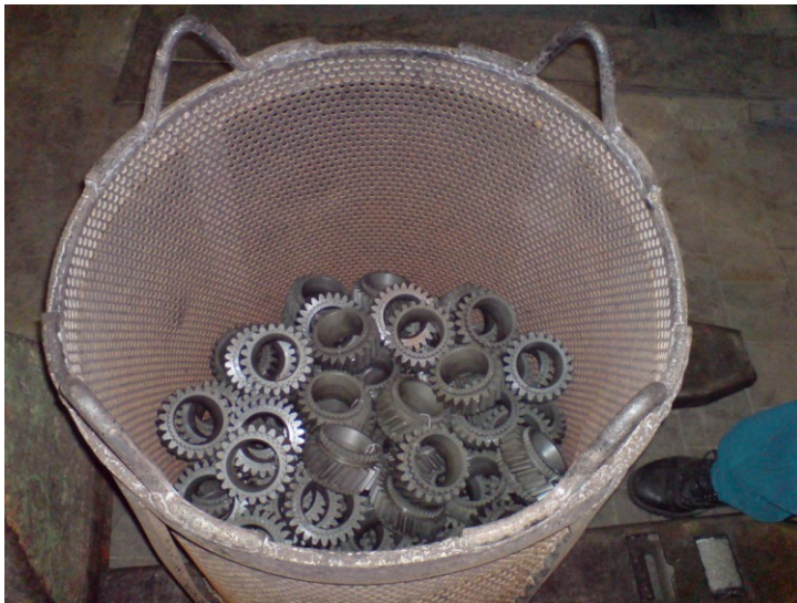
Obr. 3.2.2.1: Žíhací koš s ozubenými koly
