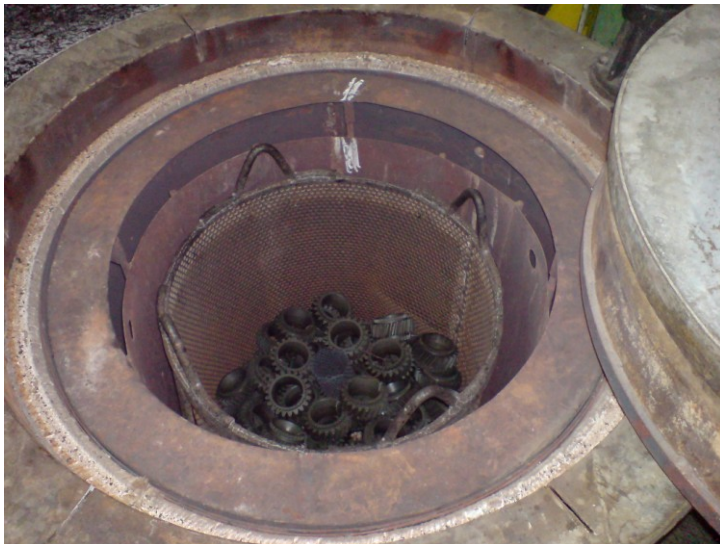
Obr. 3.2.2.2: Uložení přípravku s ozubenými koly do pece
