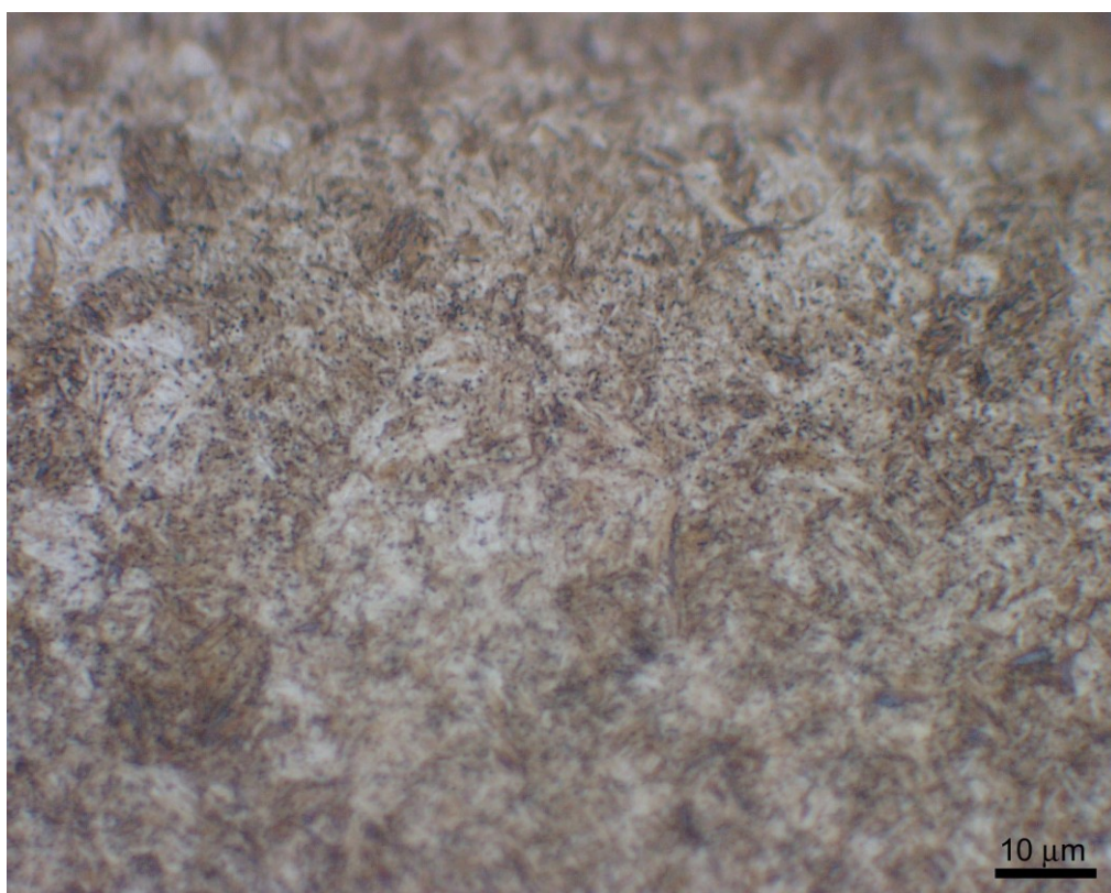
Obr. 4.4.3: Cementovaná vrstva, zvětšení 1000x
