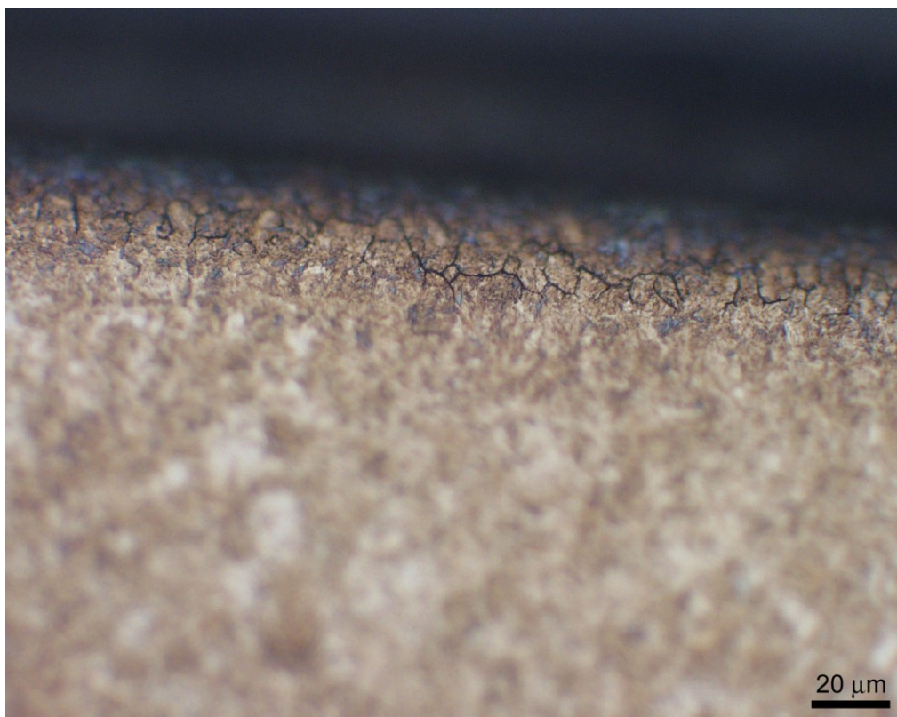
Obr. 4.4.2: Povrchová mezikrystalická oxidace, zvětšení 500x
