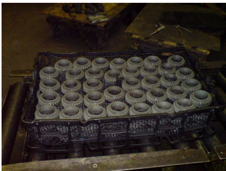
Obr. 3.2.1.2: Uložení ozubených kol v přípravku
