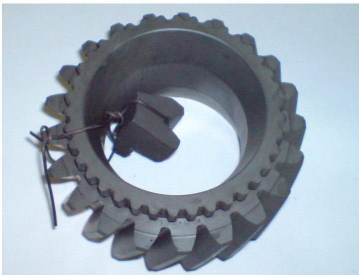
Obr. 3.3.1.1: Způsob uložení kontrolního zubu při cementaci a kalení
