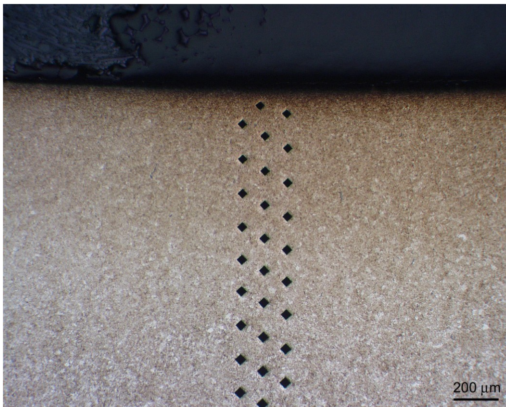
Obr. 4.4.1: Ukázka metody měření mikrotvrdosti podle Vickerse, zvětšení 50x
