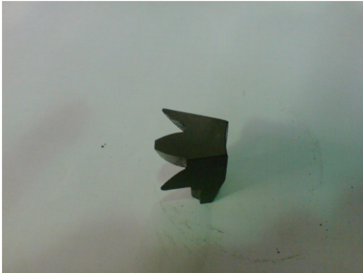
Obr. 3.3.3.1: Ukázka vzorku pro měření na rentgenu
