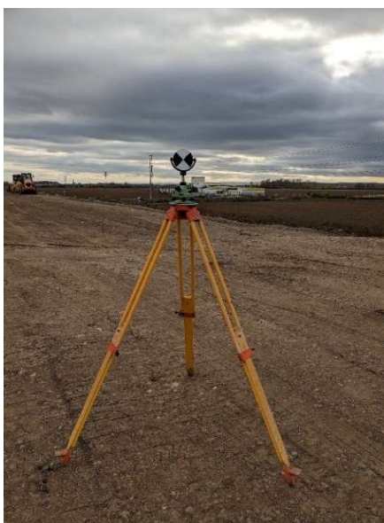
Obrázek 5.2 - Signalizační terč na stativu
