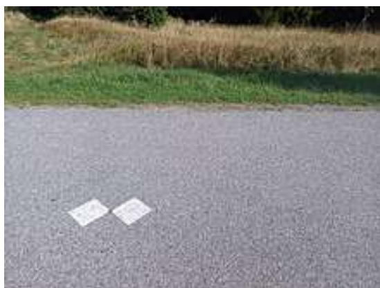
Obrázek 2.1 - Ukázka vlíčovacího bodu [6]
