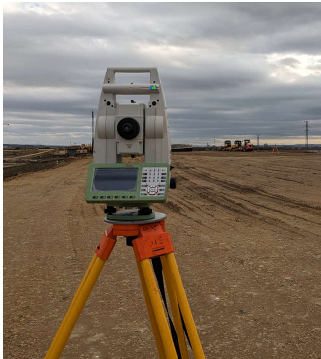
Obrázek 5.1 - Totální stanice Leica TS16
