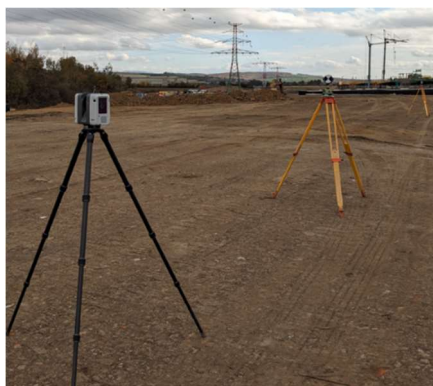
Obrázek 6.2 - Skener Leica RTC 360 a signalizační terče na stativěch
