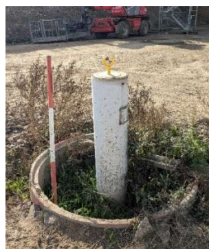
Obrázek 5.2 - Bod původní vytyčovací sítě stavby 7065
