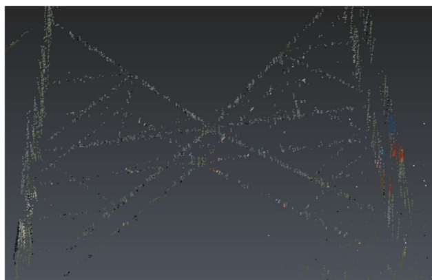
Obrázek 7.14 - Zdvojení objektů v mračnu bodů ze SLAM skeneru
