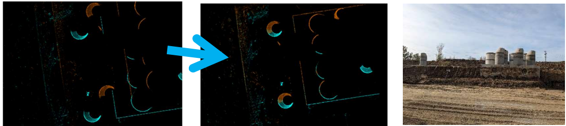
Obrázek 7.2 - Spojování mračen funkcí cloud to cloud
