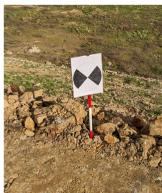
Obrázek 6.3 - Doplňkové signalizační terče
